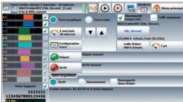
Déclenchement: de multiples possibilités, une voie, un seuil, plusieurs voies ou plusieurs seuils combinés.
